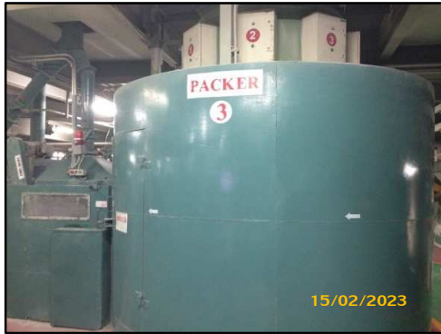
ภาพที่ 3.67 หลังคาปิดคลุมเครื่องจักรจ่ายปูนซีเมนต์
