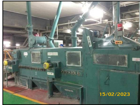
ภาพที่ 3.67 หลังคาปิดคลุมเครื่องจักรจ่ายปูนซีเมนต์
