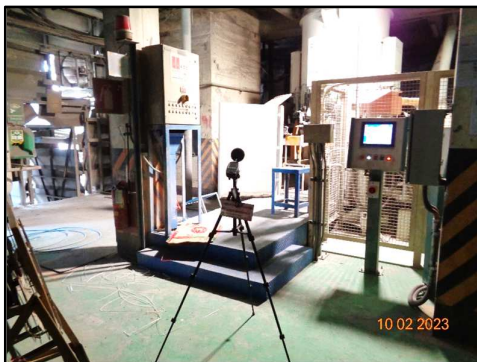
ภาพที่ 3.75 การตรวจวัดระดับเสียงของ เครื่องจักรบริเวณบรจุปูนซีเมนต์
