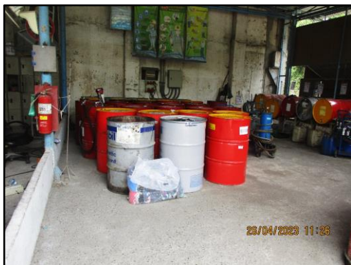
ภาพที่ 2.33 ถังเก็บน้ำมันที่เสื่อมสภาพ/น้ำมันหล่อลื่นที่ใช้แล้วจากงานซ่อมบำรุงเครื่องจักรที่เสื่อมสภาพ
