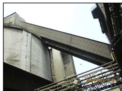
ภาพที่ 2.3 การขนถ่ายด้วยสายพานลำเลียงระบบปิดในโรงงาน
