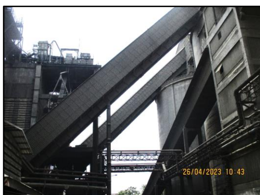
ภาพที่ 2.3 การขนถ่ายด้วยสายพานลำเลียงระบบปิดในโรงงาน
