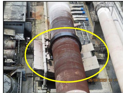
ภาพที่ 3.106 ฉากป้องกันความร้อนบริเวณ Riser pipe
