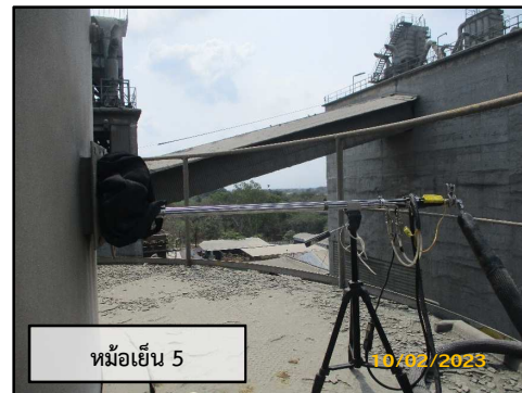
ภาพที่ 3.16 การตรวจวัด TSP จากปล่องหม้อบดลิกไนต์ ปล่องหม้อเย็น และปล่องหม้อบดซีเมนต์
