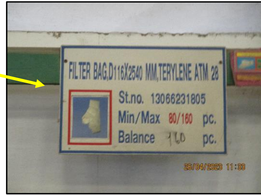
ภาพที่ 2.7 ถุงกรองสำรองและป้ายบอกขนาดสำหรับเครื่องดักฝุ่นชนิด BF
