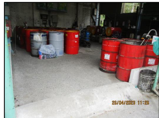
ภาพที่ 2.33 ถังเก็บน้ำมันที่เสื่อมสภาพ/น้ำมันหล่อลื่นที่ใช้แล้วจากงานซ่อมบำรุงเครื่องจักรที่เสื่อมสภาพ
