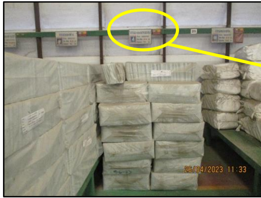
ภาพที่ 2.7 ถุงกรองสำรองและป้ายบอกขนาดสำหรับเครื่องดักฝุ่นชนิด BF
